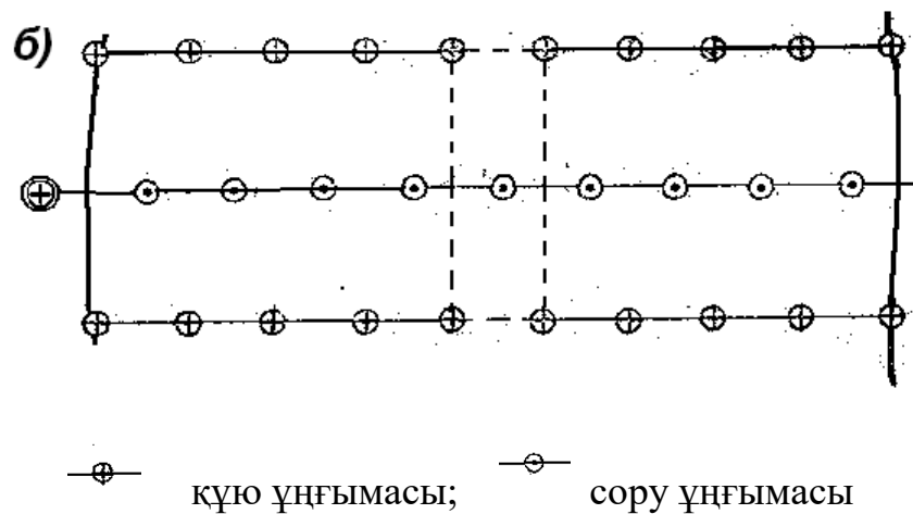
2.3 Сурет - Ұңғымалардың шахматты орналасу сұлбасы
